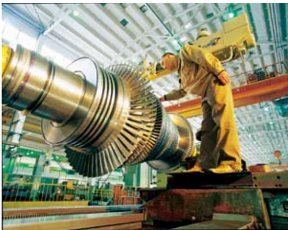
加工超大型汽轮机转子（来源于杭州图库）
